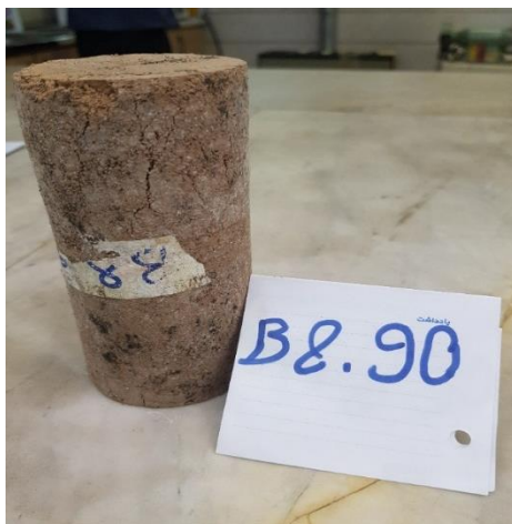
شکل ۱۴- نمونه تثبیت شده به روش زیستی با غلظت ۸ گرم بر لیتر محلول بتاگلوکان
