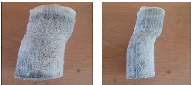
شکل ۱۲- نمونه تغییر شکل یافته ستون سنگی مسلح
