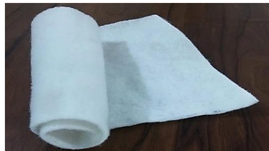
ج) ژئوتکستایل مورد استفاده جهت تسلیح ستون سنگی
