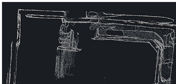
شکل ۷، نمای عمودی از برش ابرنقاط حاصل از اسکنر iPhone بدون گیمبال
