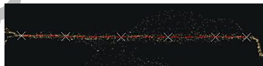
شکل ۸، برش عرضی از ابرنقاط و ترسیم نقشه دوبعدی با استفاده از رگرسیون خطی
