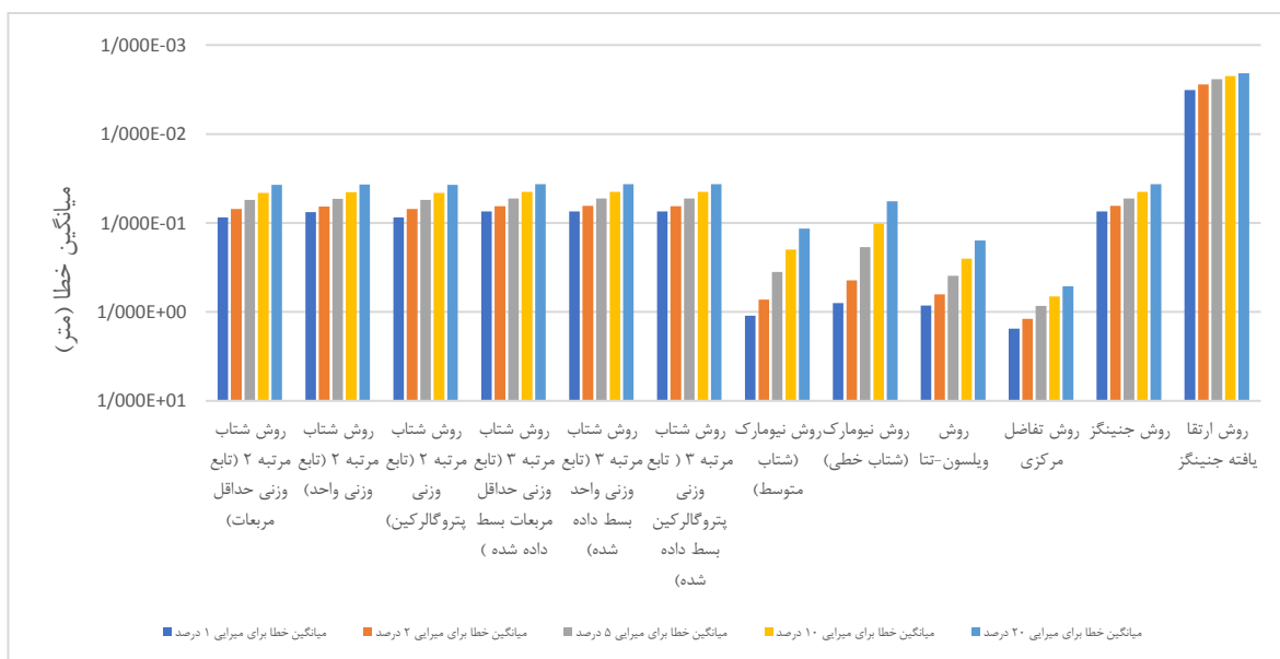
شکل ۸- میانگین خطای روش‌های مختلف عددی برای میرایی‌های ۱، ۲، ۵، ۱۰ و ۲۰ درصد برای \Delta t برابر با ۰/۱۲ ثانیه
