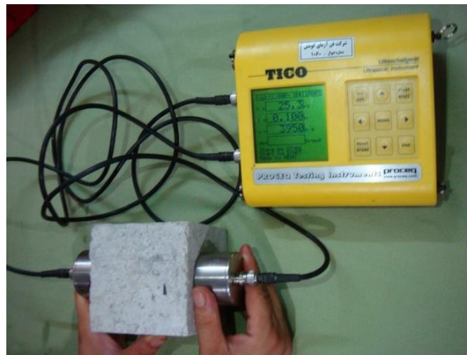
شکل ۹ انجام آزمایش اولتراسونیک (UPV)
