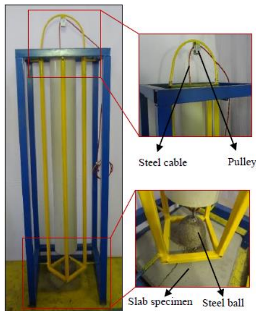
شکل ۱۱ دستگاه آزمایش ضربه وزنه افتان
