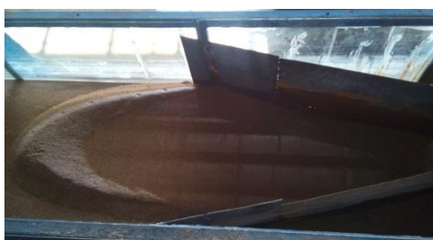
شکل ۱۶ هندسه چاله آبستنگی پایین‌دست کالورت مستطیلی
