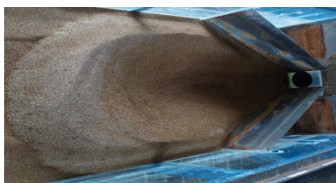
شکل ۱۵ هندسه چاله آبستنگی پایین‌دست کالورت دایره‌ای
