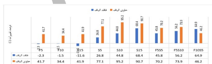
شکل ۱۰: نتایج آزمایش مقاومت فشاری در سن ۲۸ روز شکل ۱۱: مقایسه نتایج آزمایش مقاومت فشاری ۲۸ روزه نمونه‌های حاوی میکروسیلیس و فلدسپات با طرح شاهد
