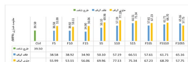
شکل ۱۰: نتایج آزمایش مقاومت فشاری در سن ۲۸ روز شکل ۱۱: مقایسه نتایج آزمایش مقاومت فشاری ۲۸ روزه نمونه‌های حاوی میکروسیلیس و فلدسپات با طرح شاهد
