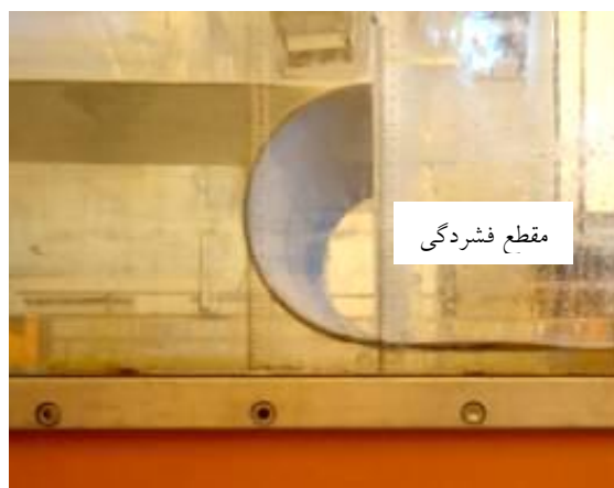
شکل ۱۰ ضریب فشردگی برابر با یک در دریچه نیم‌استوانه‌ای با قطر ۲۰۰ میلی‌متر
